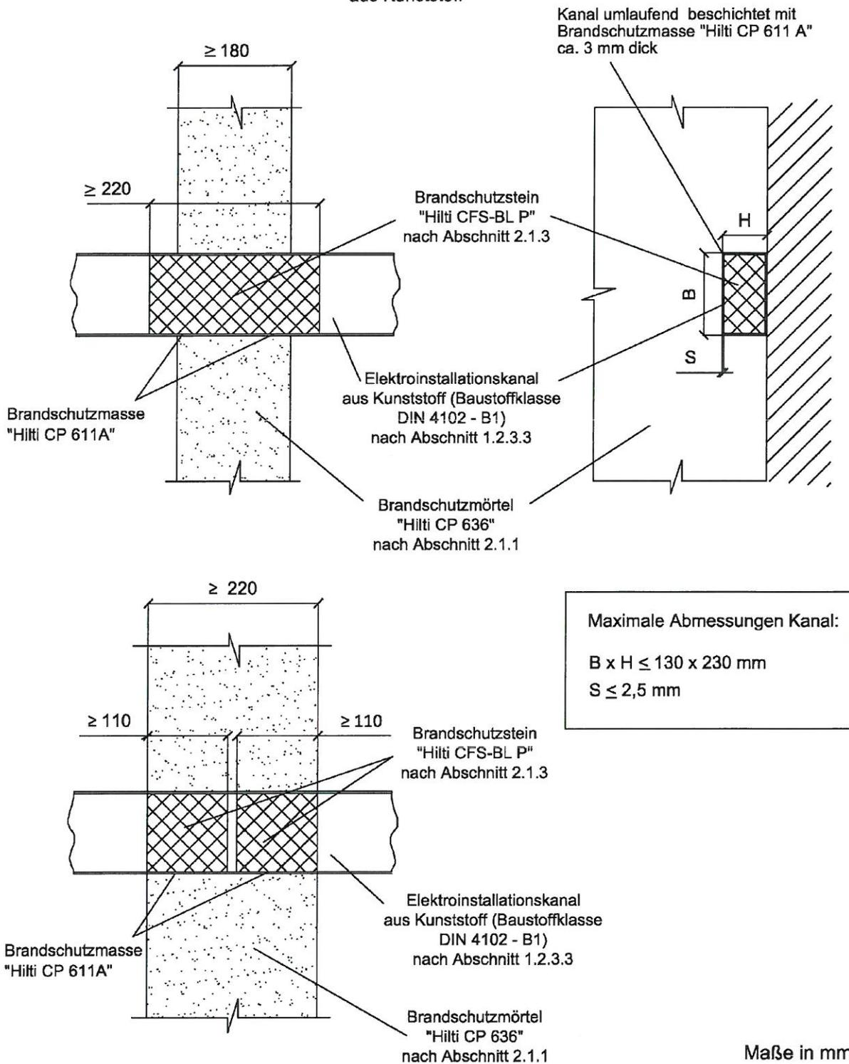
Kabelabschottung "Hilti Brandschutz-System CP 636-S 120" der Feuerwiderstandsklasse S 120 nach DIN 4102-9
